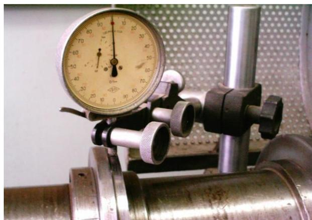
Рис. 3.6.9. Схема измерения среднего кольца (заготовки)
